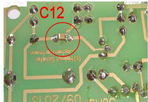
Falls C12 bedrahtet geliefert wird, Bestückung nach Aufdruck
