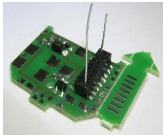
Es wird empfohlen, die Teile in der angegebenen Reihenfolge auf zu löten. Zum genauen Ausrichten der Buchse können Drahtreste  $\text{Ø} \leq 0,4\text{mm}$  diagonal eingesteckt werden. Das überflüssige Teil abbrechen und zum Brückenstecker verarbeiten (es ist nicht durchkontaktiert).
